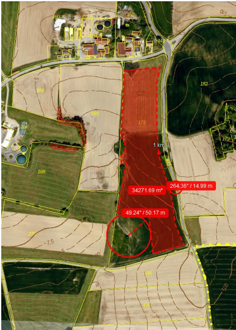
Abbildung 1: Lage des geplanten Solarparks (Quelle Geoplan) bei Aussparung des Kiebitznahrungshabitats Rot überlagerte Fläche: Umzäunter Bereich mit Modulen, roter Kreis: 50 Meter-Radius um Feuchtfläche (Kiebitznahrungshabitats), rot straffiert: kartierte Biotope aus der offiziellen Biotopkartierung
